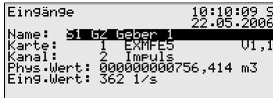
Um zur Anzeige eines anderen Kanals zu wechseln, geht man in den Eingabemodus (Eingabetaste betätigen) und selektiert in der erscheinenden Liste den Namen des gewünschten Eingangswertes. Nach Bestätigen mit der Eingabetaste wird die Anzeige für die gewählte Karte aufgeschaltet.
