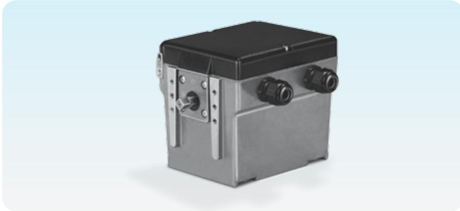
Le servomoteur GT 50 est monté directement sur une vanne papillon comme DKR par ex., pour permettre de régler le débit de gaz et d'air des brûleurs gaz. Le servomoteur GT 50 est conçu pour toutes les applications exigeant une rotation exacte comprise entre 0° et 90° ou 0° et 160°.
