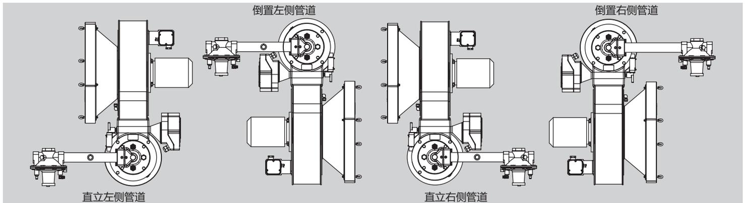
即使风机电机位于倒置单元的“左”侧，它仍然是与风机组件相关的“右侧”电机。
